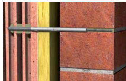
Фрагмент: Ремонт облицовки
