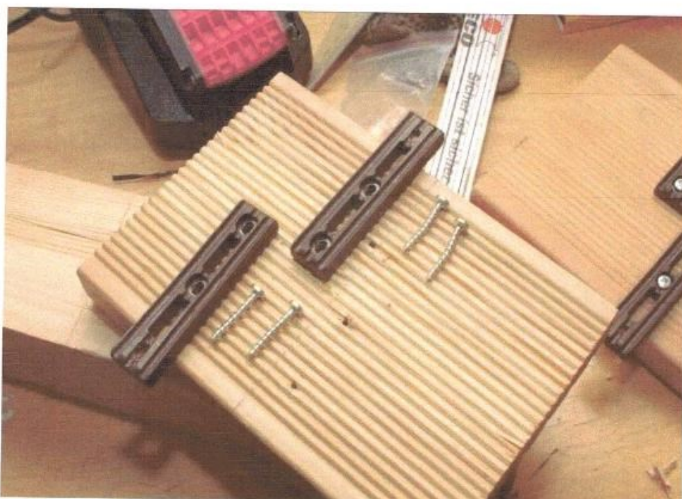
Рисунок В.14 – Разрушение пластикового элемента и деформация шурупа после испытания на сдвиг.
