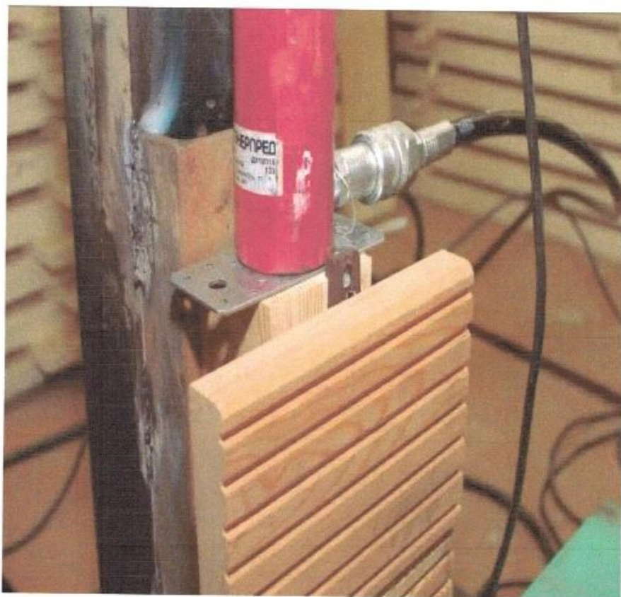
Рисунок В.11 – Разрушение образца после испытания на сдвиг.
