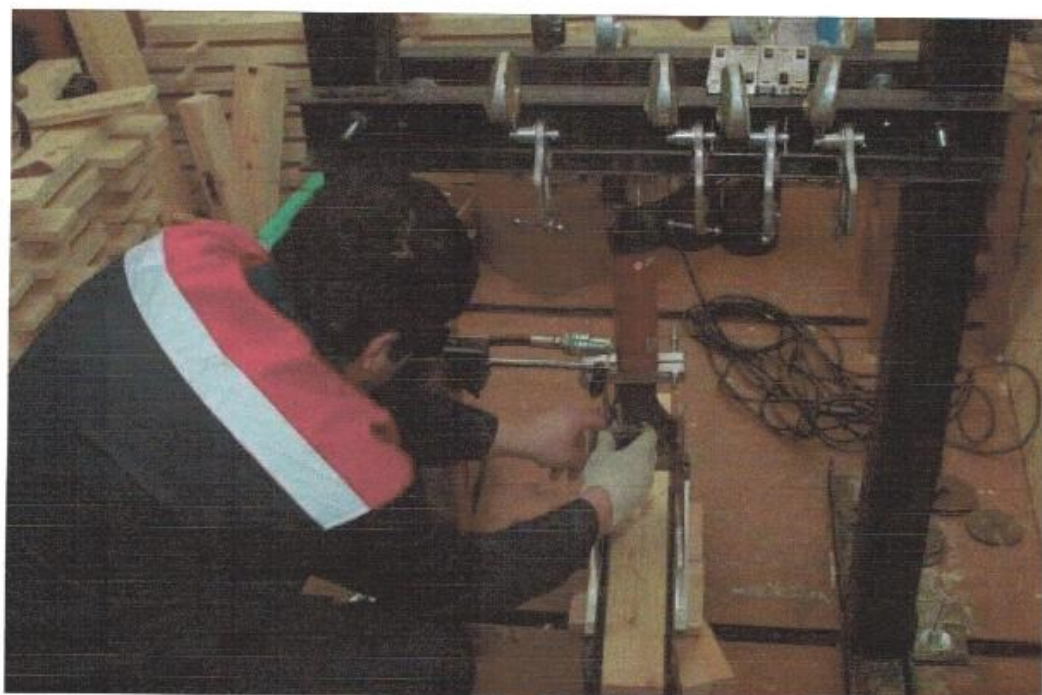
Рисунок В.16 – Сбор установки для испытания на вырыв.
