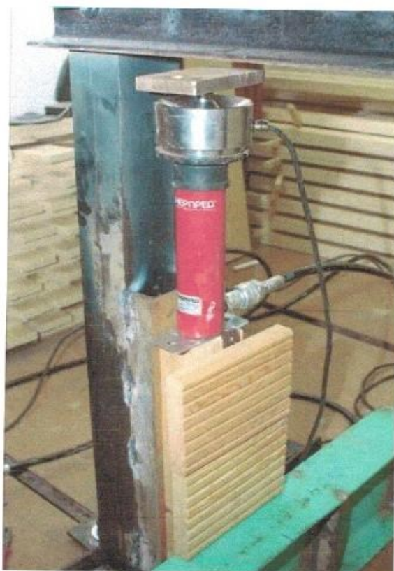
Рисунок В.10 – Разрушение образца после испытания на сдвиг.
