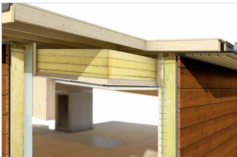
Примыкание наружной стены к кровле.
