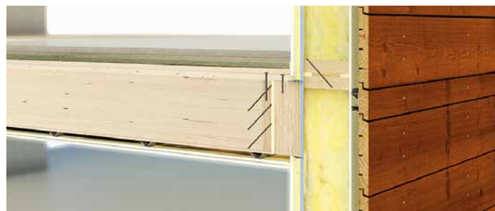
Соединение межэтажного перекрытия и наружной стены
