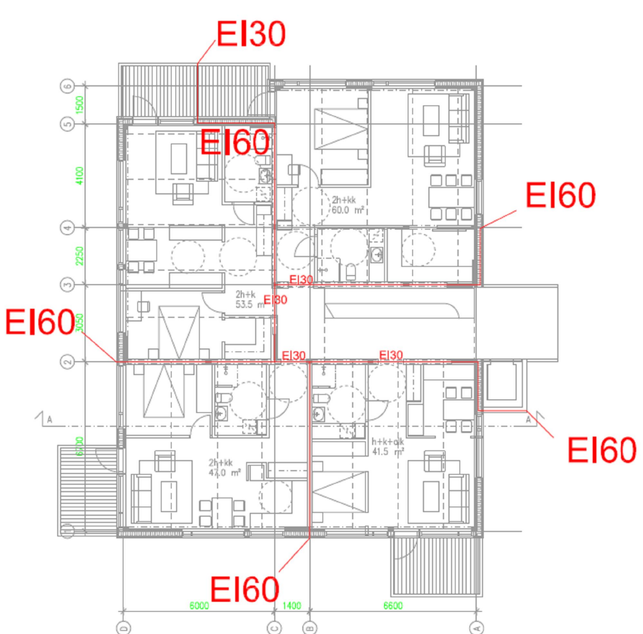
Схема 8. Классы огнестойкости для стен.
