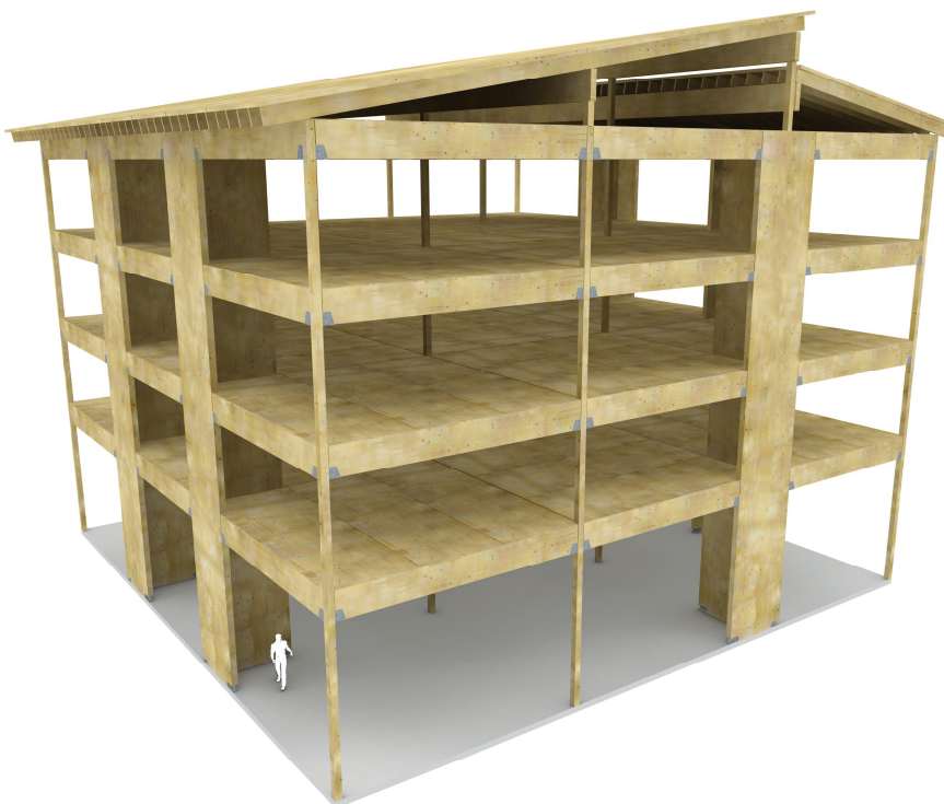
Схема 1. Конструкция трехэтажного дома с мансардой, Finnforest Kerto®.
